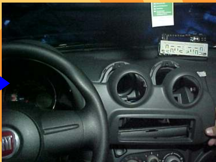
Retirando a carenagem do painel do novo UNO
