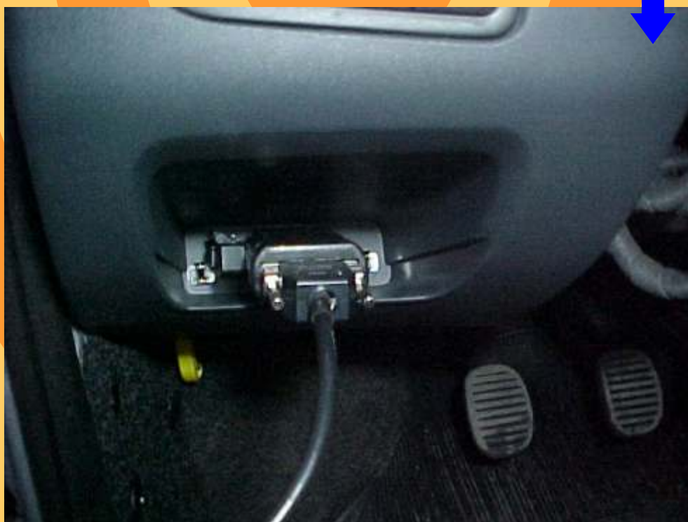
Conectando o conector OBD II MIC na tomada de diagnostico do novo UNO 2010
